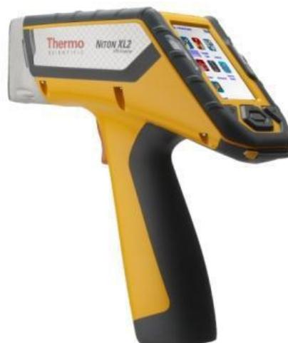
Les analyseurs « Niton XL2-XRF » sont disponibles sur place comme dispositif privilégié de dépistage du plomb. Ils sont capables de détecter la présence de plomb dans les peintures/couches de surface sur une base de détection/non-détection, en analysant la quantité de peinture dans la surface en  $\mu\text{g}/\text{cm}^2$  et  $\text{mg}/\text{cm}^2$ . Ces analyseurs sont faciles à utiliser et peuvent effectuer plusieurs analyses en quelques secondes.
